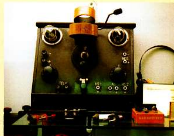
Een zelfbouw tweelampsradio. Geluidswaergave gaat via een koptelefoon.
